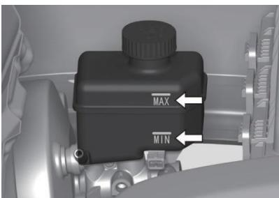
Si el nivel está bajo, añada líquido de frenos hasta la posición "MAX".
