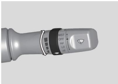
Si ajuste la rueda desde la señal estrecha hasta la señal ancha, se aumenta el tiempo intermitente y la velocidad de limpiaparabrisas se acelera cada vez más rápida.
