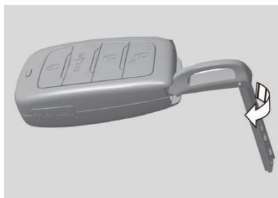
3. Retire la batería vieja y coloque una nueva (3V, batería de litio CR2032). Tenga en cuenta que el electrodo positivo de la batería está hacia arriba.
