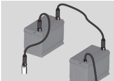
5. Si usa el vehículo para rescate, encienda el motor de la fuente de alimentación y deje que el motor funcione a una velocidad constante.
