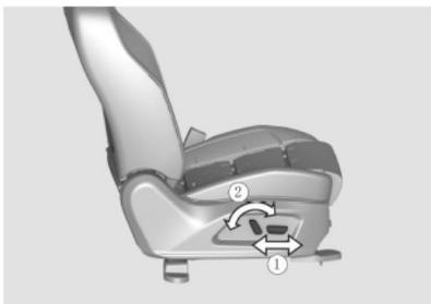
1. Ajuste de la posición del asiento hacia adelante y hacia atrás. Operar el interruptor de control 1 en la dirección deseada, soltar el interruptor para detener el movimiento y bloquear la posición del asiento.
