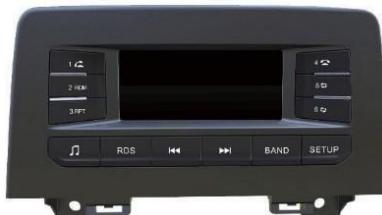
Los botones del panel se dividen en mantener presionado (presione más de 2 segundos) y presionar brevemente (presione más de 2 segundos y suelte).
