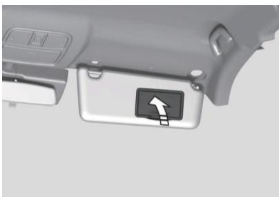
Tirar hacia abajo la visera del lado del pasajero delantero, abrir la tapa de espejo de maquillaje para usarlo.
