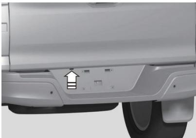
Inserte el balancín del elevador del neumático de repuesto en el orificio que como se muestra en la figura, agite el balancín para bajar el neumático de repuesto y retire la placa de fijación del neumático de repuesto para extraer fácilmente el neumático de repuesto.
