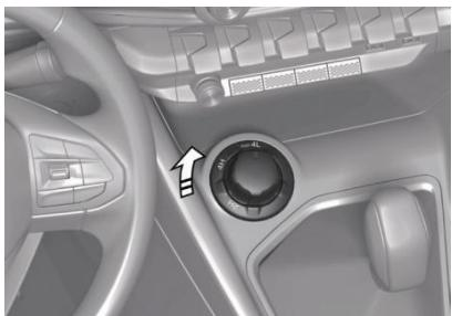
Gire el interruptor de tracción 4x2 / 4x4 para seleccionar tres modos de conducción.
