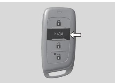
Una vez bloqueadas todas las puertas, presione el botón de búsqueda dos veces en 2 segundos, se activará la función de búsqueda, la bocina emitirá un pitido dos veces y el intermitente parpadeará por aproximadamente 15 segundos para indicar la ubicación del vehículo. Presione el botón de desbloqueo durante el parpadeo, se abrirá la puerta inmediatamente.
