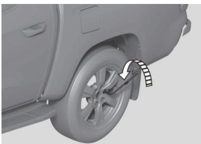
6. Conecte el gato, el balancín y la llave de la tuerca de la rueda para colocar el gato correctamente en la parte superior de la parte superior del vehículo más cercano al neumático desinflado
