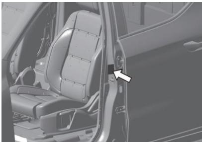
La identificación de presión de neumáticos se encuentra sobre el pasador de bloqueo del marco de la puerta del lado de conductor.
