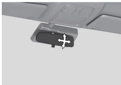
Según la postura de conducción, el espejo retrovisor puede ajustarse hacia arriba, o hacia abajo y hacia la izquierda, o hacia la derecha.
