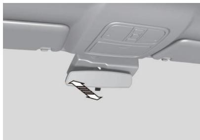
La función antideslumbrante se puede activar o desactivar con la palanca de ajuste según sea necesario.
