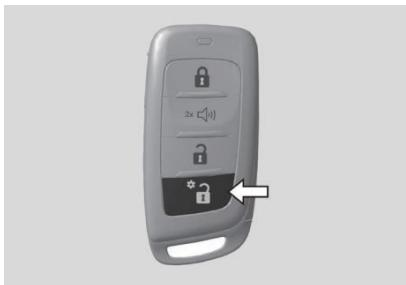
Mantenga presionado el botón de cambio del modo de desbloqueo por 5 segundos en la llave inteligente, se podrá realizar cambio entre el modo de desbloqueo de la puerta del conductor y el modo de desbloqueo de cuatro puertas.
