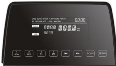
La pantalla es una pantalla de código de segmento. La pantalla muestra la banda de frecuencia de radio, reloj, USB y señales de radio.
