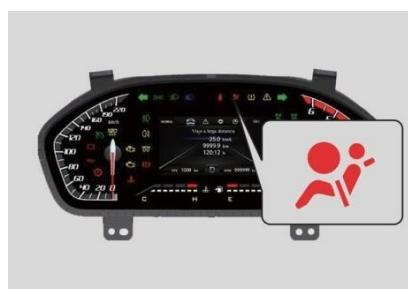
Cuando la fuente de alimentación del vehículo completo está en la posición ON, este indicador se encenderá por aproximadamente 3-6 segundos luego se apagará. En condiciones normales de trabajo, la luz indicadora de la bolsa de
