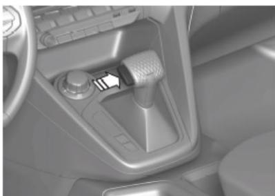
Después de arrancar el motor, realice los cambios de marcha de manera normal. Cuando cambie de las siguientes posiciones, deberá presionar el botón de desbloqueo en la palanca de cambios: P → R, R → P, N → R.
