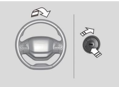
Cuando se apaga el interruptor de encendido y se retira la llave, la columna de dirección se bloquea y el volante no se puede girar en este momento.
