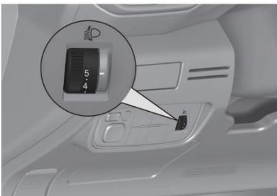
Con el cambio de estado de carga, aceleración o reducción u otras situaciones del vehículo, la postura corporal del vehículo se cambia, y se puede realizar el ajuste para el ángulo de inclinación de la luz baja mediante el interruptor.
