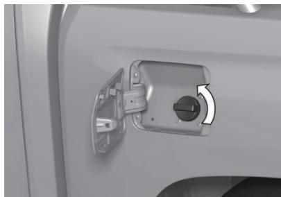
5. Coloque la tapa del tanque de combustible en la parte posterior del tapón de llenado.
