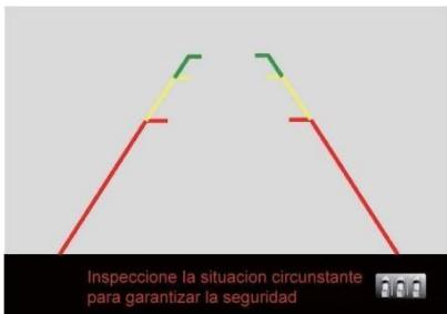
Si se gira el volante, las líneas de anchura vehicular y las líneas de referencia de distancia (se llaman uniformemente comola trayectoria dinámica) se modificarán según el ángulo del volante y estimará la trayectoria de retroceso vehicular, después de la confirmación, mantenga el volante, el vehículo retrocederá según la trayectoria dinámica.
