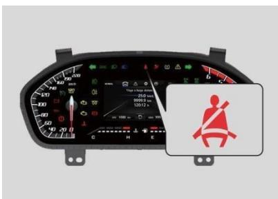
Luz indicadora del cinturón de seguridad encenderá en el caso de que el conductor y pasajero delantero no haber llevado el cinturón.
