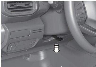
2. Mueva el volante en la dirección vertical para ajustarlo a la posición correcta.
