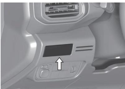
El salpicadero al lado del conductor está equipado con portavaso oculto retractable. Presiónelo para abrir.
