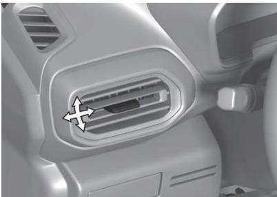
Mueva el botón hacia arriba, hacia abajo, a la izquierda y a la derecha para orientar el flujo de aire hacia el lado izquierdo o el lado derecho, el lado superior o el lado inferior.
