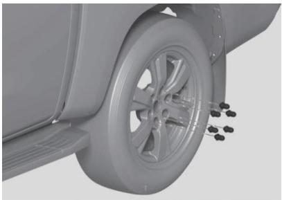
10. Si hay material extraño en la superficie de contacto de la rueda, elimínelo.
