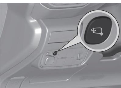
El espejo retrovisor exterior se puede plegar presionando el interruptor de doblado del mismo. Presione nuevamente, se desplegará el espejo retrovisor exterior.
