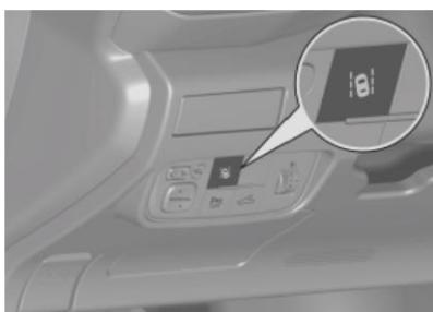
Cuando el interruptor LDW está en la posición ON y el vehículo está encendido, se puede activar o desactivar el sistema presionando el botón LDW.
