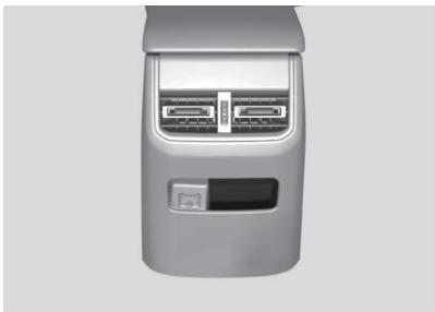
La caja de almacenamiento trasera está ubicada en la parte inferior de la salida de aire trasera.
