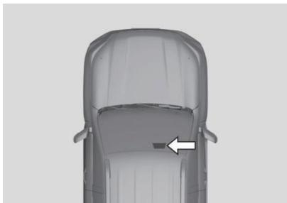
La ventanilla de microondas está ubicada en la parte superior derecha del parabrisas delantero. La ventanilla de microondas no puede ser tapada por los soportes del sensor de lluvia o de salida de camiles.
