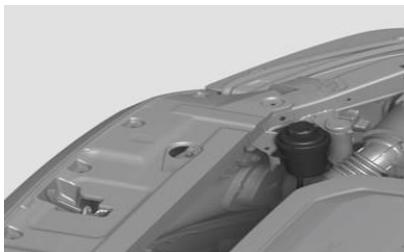
Apague la fuente de alimentación del vehículo y verifique regularmente el nivel del líquido de la dirección asistida para asegurarse de que el aceite se encuentre entre los marcados MAX (máximo) y MIN (mínimo).
